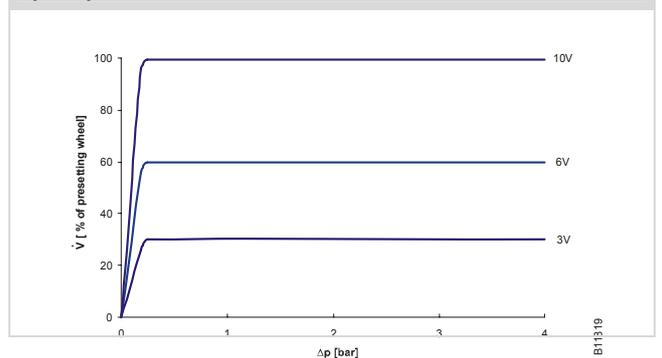
Пример: DN 15 VCL015F210 со значением макс. поток 210 л / ч. Поток как функции контролируемая напряжением(0 ... 10 В ) и дифференциального давления
