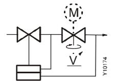
Комбинация VCL с электрическими приводами 230 V (2-/3- поз)
