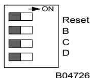
Переключатель перезапуска находится в положении «ВКЛ» в течение, приблизительно, 0,5 сек, чтобы загрузить микропрограмму из ППЗУ и начать работу в определенных условиях старта.
