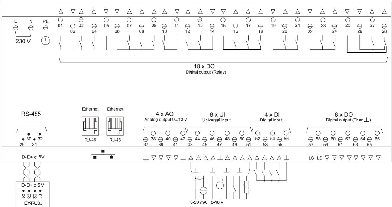
Для соответствия стандарту (EN 61000-6-2), подключаемые кабели для бинарных входов (DI), аналоговых входов и выходов (AI/AO) и кабели RS485 должны быть не длинее 30-ти метров.
