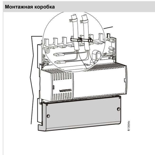
Кабели обратных сигналов от датчиков Ni1000 и Pt1000 должны быть отделены от других входов или выходов (DI 1.2 mA, 0...20 mA), т.е. должны использоваться различные клеммы GND (⊥).
