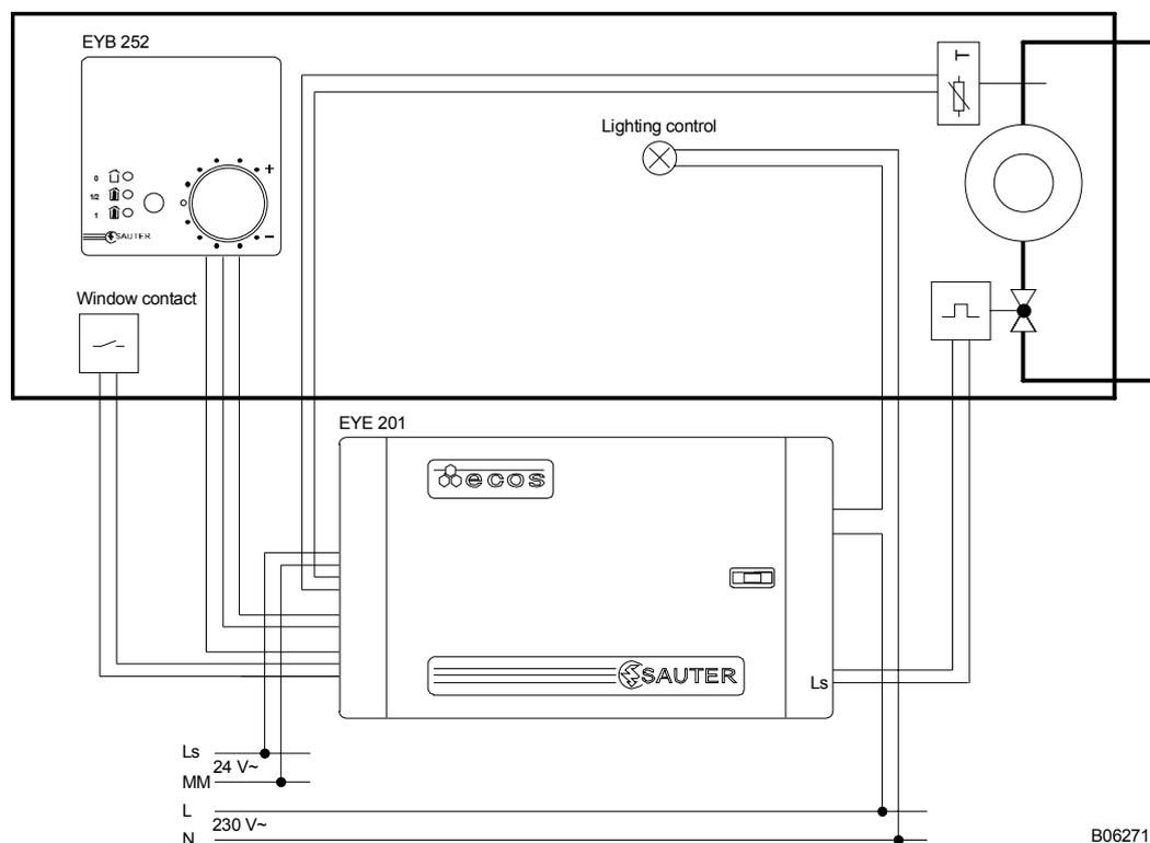
Потолочная система охлаждения с переменной вентиляцией (постоянный объем воздуха) и радиаторным отоплением, с компенсацией потерь тепла через окно; централизованное регулирование влажности.
